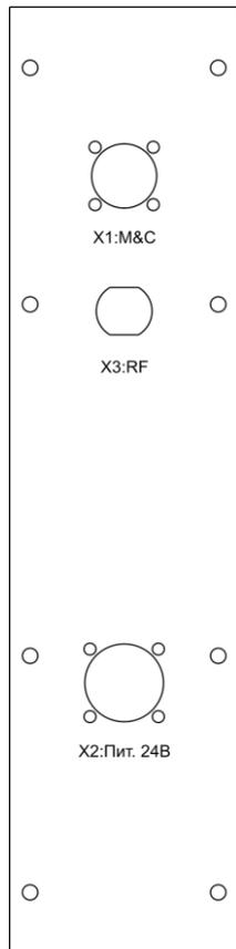
Рисунок 14 - Внешний вид переходной панели
